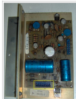
(/wiki/Fichier:Gtb_sys1_psu_A2J1_Fichier:Gtb_sys1_psu_A2J1_highl.jpg) Carte d'alimentation System1 avec mise en évidence du connecteur A2J1.
