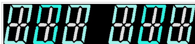
(/wiki/Fichier:Gtb_6digit_slam_scaled.gif) Illustration d'un afficheur affecté par un contact de Tilt Slam (/wiki/Fichier:Gtb_6digit_slam_scaled.gif) ouvert.
