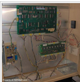
(/wiki/Fichier:Gtb_sys1_boardset.jpg) Jeu (/wiki/Fichier:Gtb_sys1_boardset.jpg) de cartes sur Gottlieb System1.
