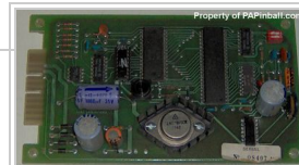
(/wiki/Fichier:GTB_Sys1_sound_ver2.JPG) (/wiki/Fichier:GTB_Sys1_sound_ver2.JPG) Carte Multi-sons System1.
