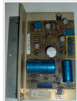
(/wiki/Fichier:Gtb_sys1_psu_A2J3_Fichier:Gtb_sys1_psu_A2J3_highl.jpg) Carte d'alimentation System1 avec connecteur A2-J3 en surbrillance.
