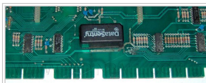
(/wiki/Fichier:Gtb_sys1_data_sentry.JPG) Carte-mère (/wiki/Fichier:Gtb_sys1_data_sentry.JPG) System1 encore équipée d'une batterie NiCad "Data Sentry". Notez qu'U5 a été déposé de cette carte.
